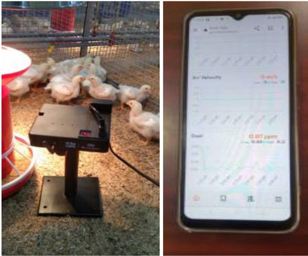
चित्र 9: व्हाइट लेगहॉर्न (कुक्कुटों की एक प्रजाति/नस्ल) कुक्कुटों में स्वरोच्चारण के माध्यम से दबाव का पता लगाने के लिए फैब्रिकेट किए गए ताररहित सेंसर नोड का प्रयोग करके फार्म की रीअल टाइम पर्यावरणीय निगरानी हेतु परीक्षण
